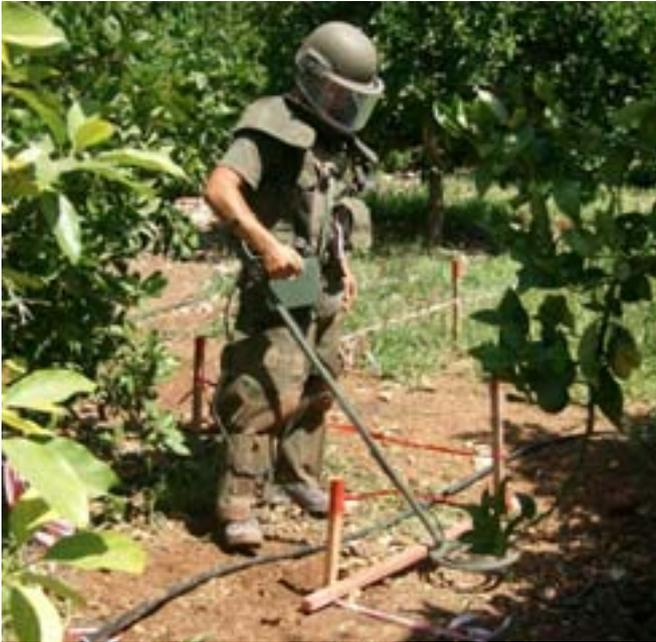
Un operatore effettua la ricerca con il metal detector Schiebel AN19/2.
